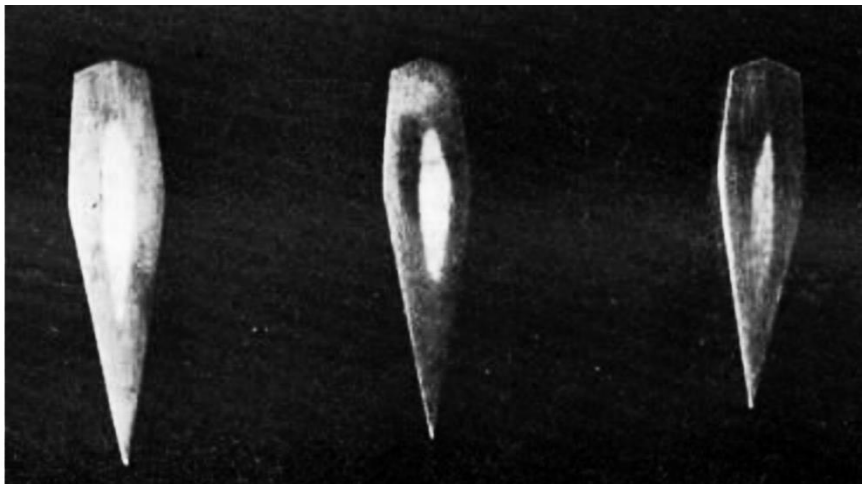
Рис.3 - Разрезы клинков Коа Иссин, изображённые в книге о Коа Иссин. Здесь показано, как шинганэ правильно расположен внутри каваганэ.
